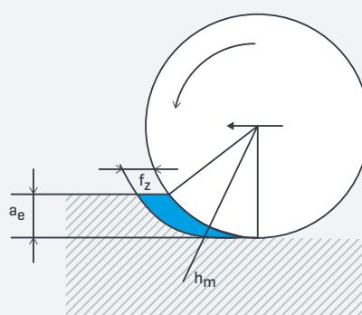
**D** Beim trochoidalen Fräsen verändern sich die Schnittbedingungen, Eingriffsbreite und Eingriffswinkel während des Bearbeitungsprozesses ständig, um eine möglichst konstante Spanmittendicke zu erzielen. Das ist in erster Linie von der verwendeten CAM-Software abhängig. Unsere Schnittwertempfehlungen sind Richtwerte. Die für den jeweiligen Anwendungsfall optimalen Einsatzwerte sollten während der Bearbeitung angepasst werden. Gerne stehen wir Ihnen bei Fragen dazu unterstützend zur Seite.
